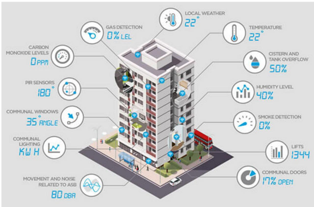
Fig.14 Exemple de données pouvant être captées par des technologies IoT
