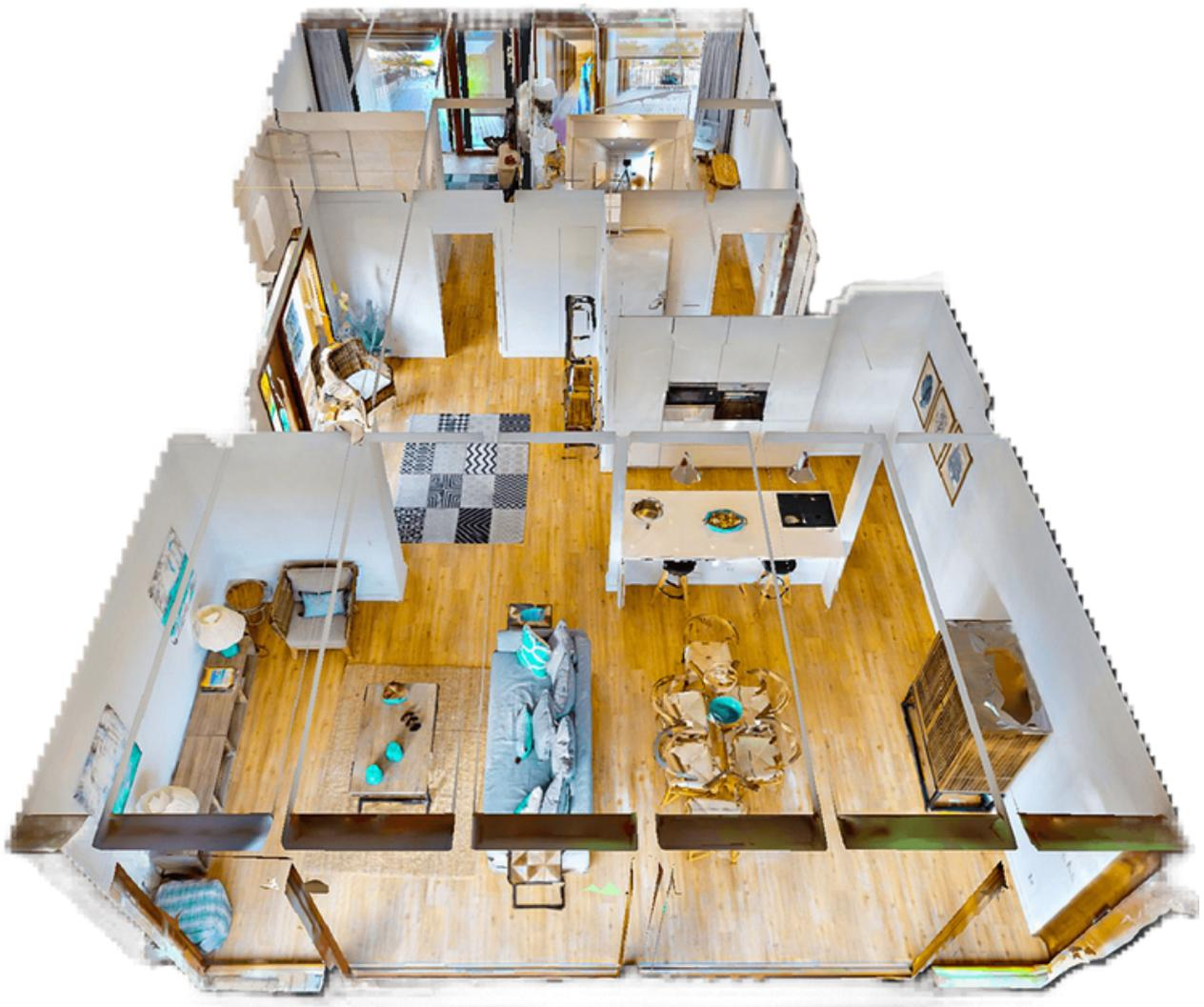
Fig.4 Exemple de modélisation 3d d'un appartement après captation par photogrammétrie
