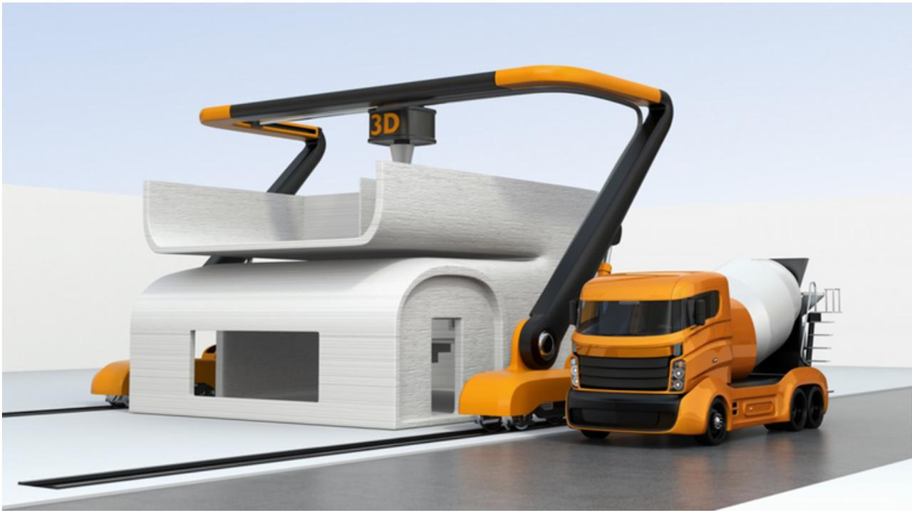
Fig.7 Concept d'engin de chantier d'impression 3D
